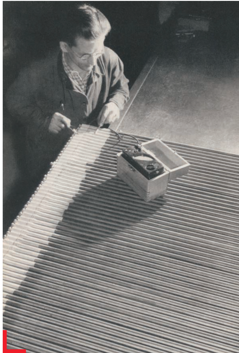
Die Troforstäbe wurden mit 7500 Volt geprüft und mit einer Spannung von maximal 3000 Volt betrieben.
